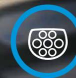
Serienmäßig ist der Renault ZOE mit einem Mennekes® Typ-2-Stecker ausgestattet, der mittlerweile zum europäischen Standard geworden ist. Daher ist der größte Teil neu gebauter Ladestationen in Europa mindestens mit einem Typ-2-Anschluss ausgestattet.
