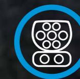
Das Combined Charging System (CCS)<sup>1</sup> ergänzt den Typ-2-Stecker mit zwei zusätzlichen Leistungskontakten (Pins) um eine Schnellladefunktion und unterstützt AC- und DC-Laden. Für das Schnellladen wird kein weiteres Ladekabel benötigt, da diese bereits an den Ladesäulen vorhanden sind. Wird das Fahrzeug mit dem Mennekes® Typ-2-Stecker mit Wechselstrom geladen, müssen die zwei zusätzlichen Pins nicht besetzt sein.
