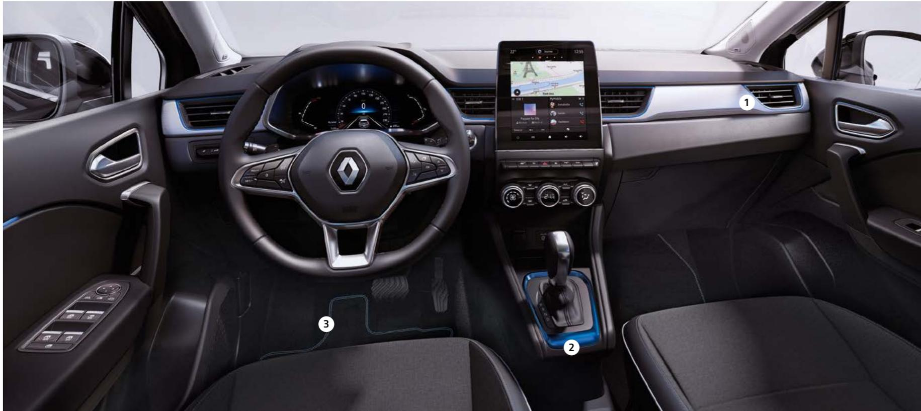
Innenlook-Paket in Blau 1. Lüftungsdüsen 2. Einfassungen am Schalthebelknopf 3. Fußmatten
