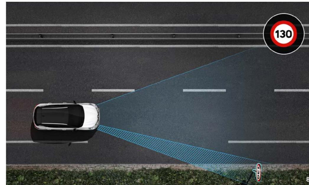
**8. Geschwindigkeitswarner mit Verkehrszeichenerkennung.** Die Kamera des Renault Captur erkennt Verkehrschilder und die geltenden Geschwindigkeitsbeschränkungen und das System weist Sie darauf hin, wenn Sie die zulässige Höchstgeschwindigkeit überschreiten.
