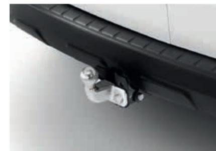
Die **STANDARD-ANHÄNGERKUPPLUNG** ist geeignet für die Kupplung mit Fangmaul oder Zughaken. Für alle gewerblichen Verwendungszwecke. Die **FESTSTEHENDE ANHÄNGERKUPPLUNG** wurde für eine intensive Nutzung entwickelt. Eine **ABNEHMBARE ANHÄNGERKUPPLUNG** (o. Abb.) ist auch erhältlich.
